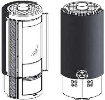
Тепловой экран для установки на задней стенке печи Marlena: позволяет поднести печь на расстояние не более 10 см от горючих стен
